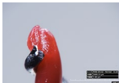
写真 8: NRA 封印ワイヤー切断面
