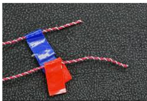
写真6： NRA 封印ワイヤー（拡大）
