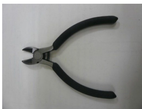
写真 10 未使用の NRA 封印ワイヤーの切断に使用した一般的なニッパ
